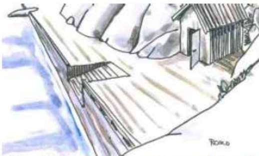
Utsparing/rampe i brygge kan også benyttes til landstigning fra kano. (Skisse og ferdig anlegg Torvhola)
